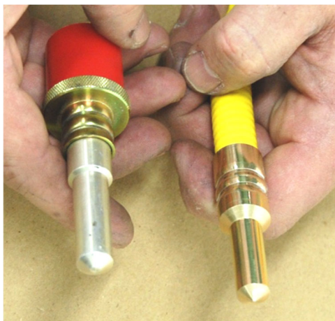
Obr. 7 – Sejmутí vyjížděcí hadice a pevné koncovky
